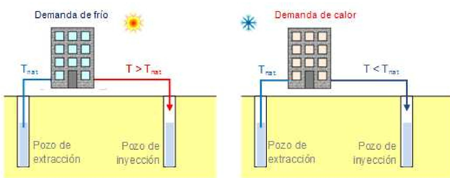
Sistema geotérmico de bucle abierto en una dirección,
