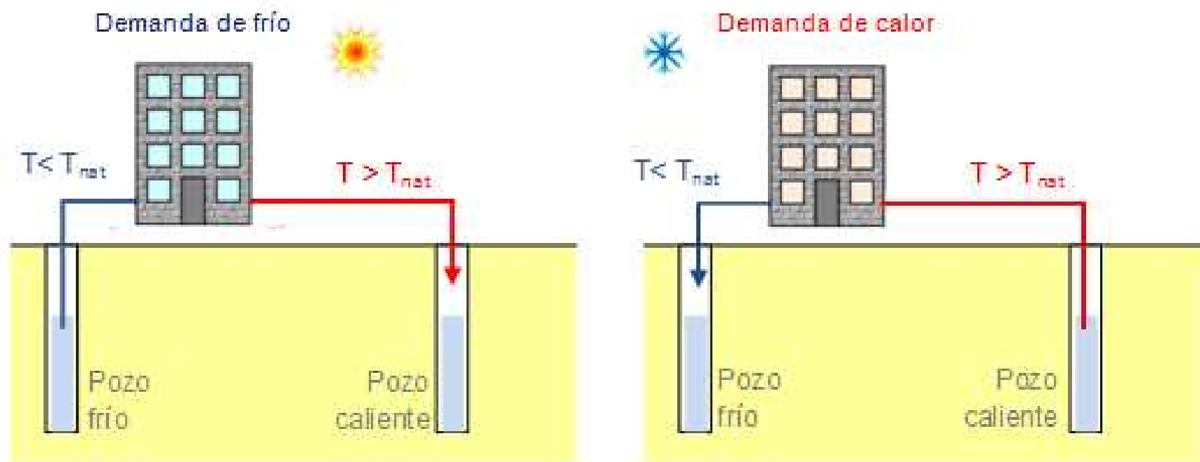
Sistema ASET-A con flujo variable para el almacenamiento estacional de energía térmica
